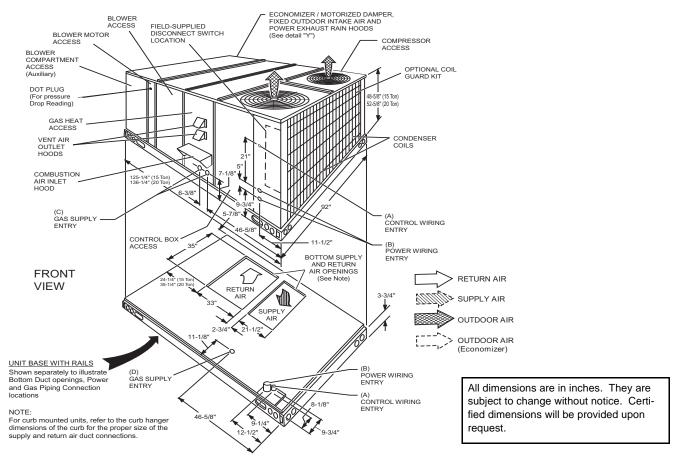
FIGURE 10 : UNIT DIMENSIONS DHG180 & 240 (FRONT VIEW)
